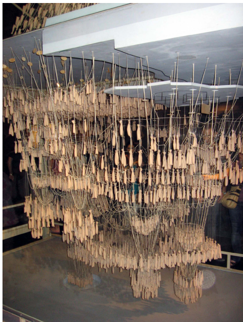
Abbildung 5: „Fädenmodell - Maqueta polifunicular, Antoni Gaudí, Museo de la Sagrada Familia“ Quelle Canaan (wikipedia)
